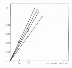
Fig. 6 — Variação da cor com a concentração de cineol para diversos comprimentos de onda
