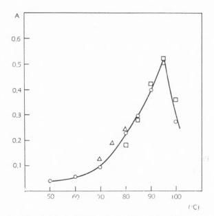
Fig. 18 — Influência da temperatura sobre a absorvência Composição: 12,0 mg/cm³ de cineol Tempo de aquecimento: 4 min. Tempo de desenvolvimento da cor: 20 min. Comprimento de onda: 650 nm
