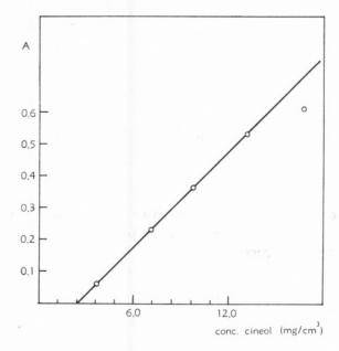
Fig. 21 — Lei de Beer Aquecimento: 85°C — 6.5 min. Comprimento de onda: 650 nm
