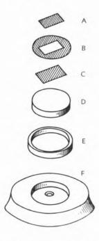
Fig. 3 - Esquema de montagem das amostras radioactivos
