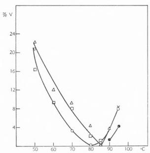
Fig. 19 - Variação dos valores das absorvências com o tempo para diversas temperaturas de aquecimento e diversas concentrações de cineol
