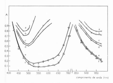
Fig. 22 — Curvas de absorção (brancos: álcool etílico)
