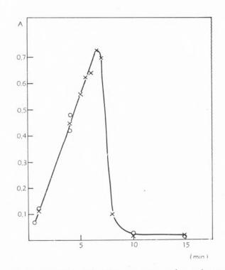
Fig. 20 - Variação de absorvência com o tempo de aquecimento Composição: 12,0 mg/cm3 de cineol Temper. de aquecimento: 85°C
