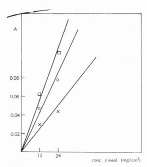
Fig. 7 — Variação da cor com a concentração de cineol para diversos comprimentos de onda
